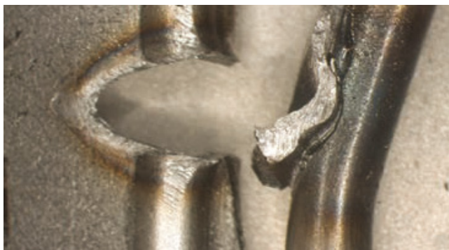
Fig. 1 - Resistenza a trazione di un giunto tra filo longitudinale e top.
