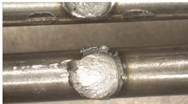
Fig. 2 - Resistenza a trazione di un giunto tra filo longitudinale e ring.
